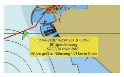
In der Regel benötigt ein AIS-Transponder ein GPS-Modul, welches für die Aussendung der Positionsinformationen, aktuelle Signal braucht.
