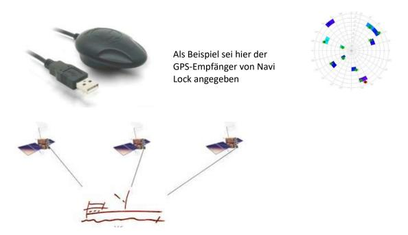
Mit dem GPS-Modul wird die aktuelle Position festgestellt und über die Schnittstelle im NMEA 0138 Protokoll, ein Standard für die Kommunikation zwischen Navigationsgeräten, GPS und PCs in der Schifffahrt, übertragen.
