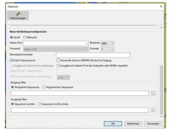
Hier wählen Sie die Schnittstelle (Daten Port) aus, die mit dem GPS/AIS verbunden ist. Dies ist meistens eine Serielle Schnittstelle. Nun stellen Sie die Baudrate auf den Wert, der im GPS/AIS eingestellt ist.
